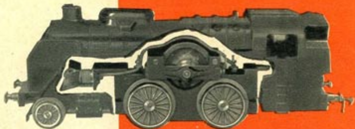
Vue en coupe de la locomotrice 6065-LT
