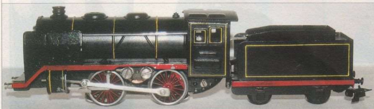
● Loco vapeur 020 R 700 en zamac avec tender à essieux en tôle. 1935-1938.
