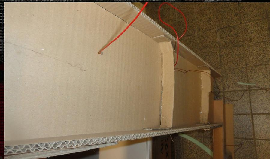
Les fils d'arrivée de courant aux rails sont passés à travers le carton. Ils seront soudés ensemble ou rassemblés par un Domino électrique, puis raccordés au transformateur.
