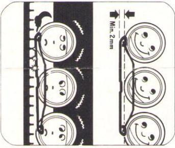
Si la locomotora commuta a alta tension de alumbrado, torcer un poco el gancho de fijación del muelle en dirección "a". Si la conmutación se retrasa, torcer el gancho de fijación del muelle en dirección "b".
